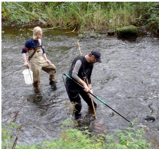
Figur 26. Elfiske med stationärt landbaserat aggregat (bensingenerator) i Svartån. Staven med ring som anlockar och bedövar fisken med hjälp av likström (200–1000 Volt, 0,3–0,7 Ampere). Fisken fångas sedan med håven som hålls strax bakom. Fångsten lämnas till medhjälparen som har en hink med vatten och sköter elkabeln till elverket på land.
