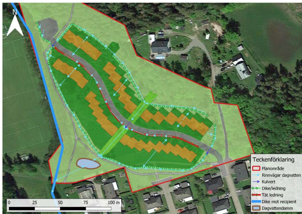
Schematisk skiss över föreslagen dagvattenlösning och ytanspråk för dagvattendamm (Geosigma).
